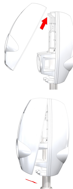
Figure 10 : Installation des coques
