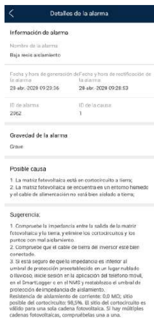
Figura E-1 Detalles de alarma
