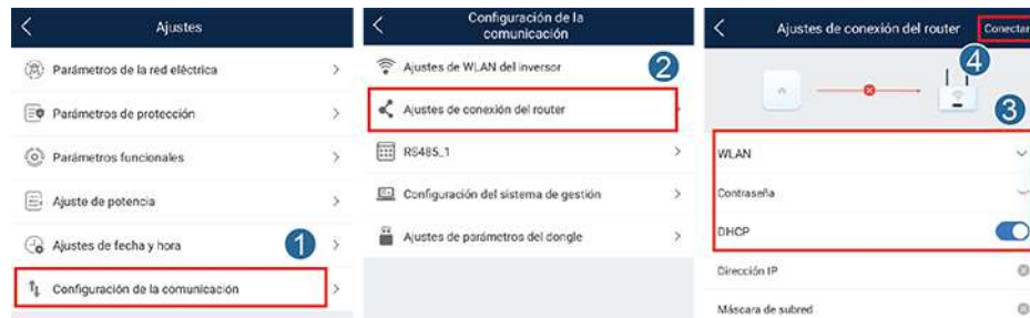
Figura C-2 Configuración de los parámetros del router
