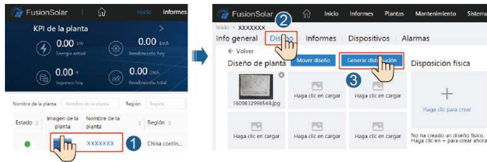
Figura 7-6 Diseño físico de los módulos fotovoltaicos
