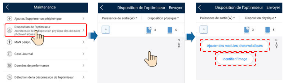
Figure 7-7 Disposition physique des modules PV
